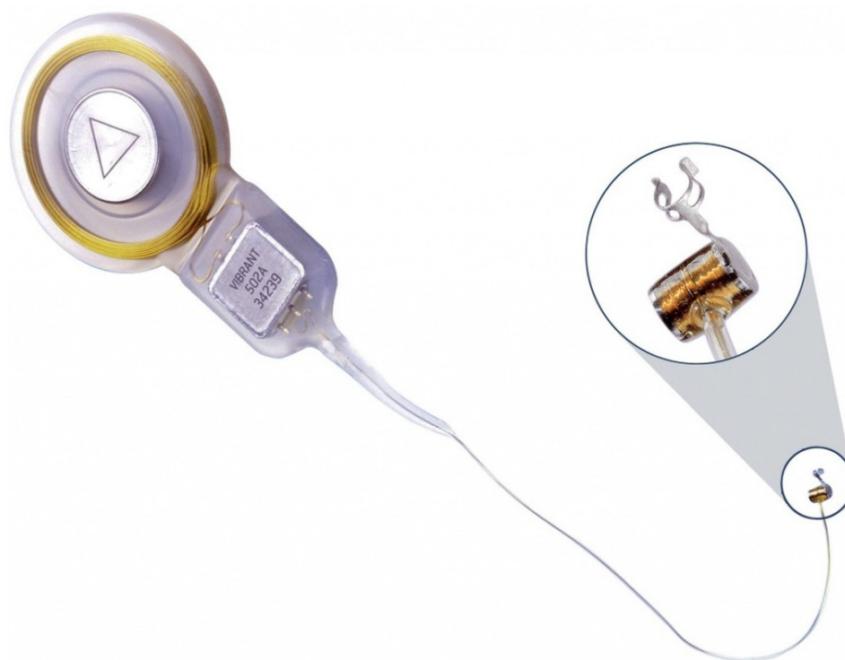
Figura 2. Ilustração do componente interno VORP da prótese ativa de orelha média Vibrant Soundbridge (MED-EL)
